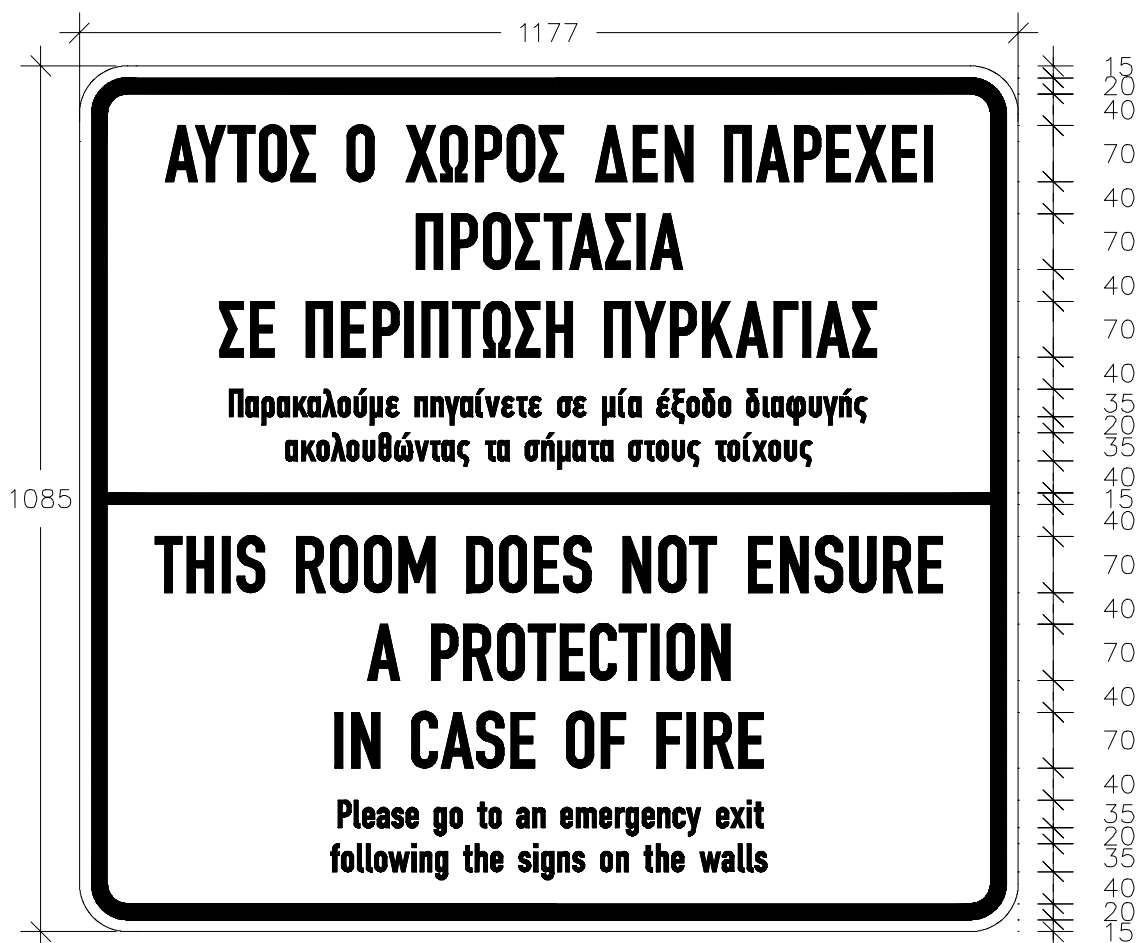
Σχήμα 20.6-4: Πινακίδα τοποθετούμενη σε εσοχές της σήραγγας όπου δεν προσφέρεται προστασία από πυρκαγιά
