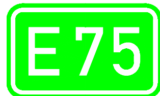
Σχήμα II: Έμβλημα με τον αριθμό της κύριας διεθνούς οδικής αρτηρίας (E-road) ( 1 e = 1/7 z , z = ύψος στοιχείων εμβλήματος)
