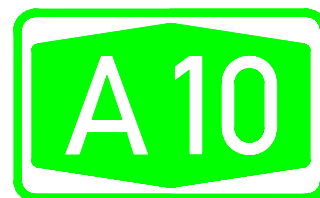
Σχήμα Ι: Έμβλημα με τον αριθμό του αυτοκινητοδρόμου Διαστασιολόγηση (1 e = 1/7 z, z = ύψος στοιχείων εμβλήματος)
