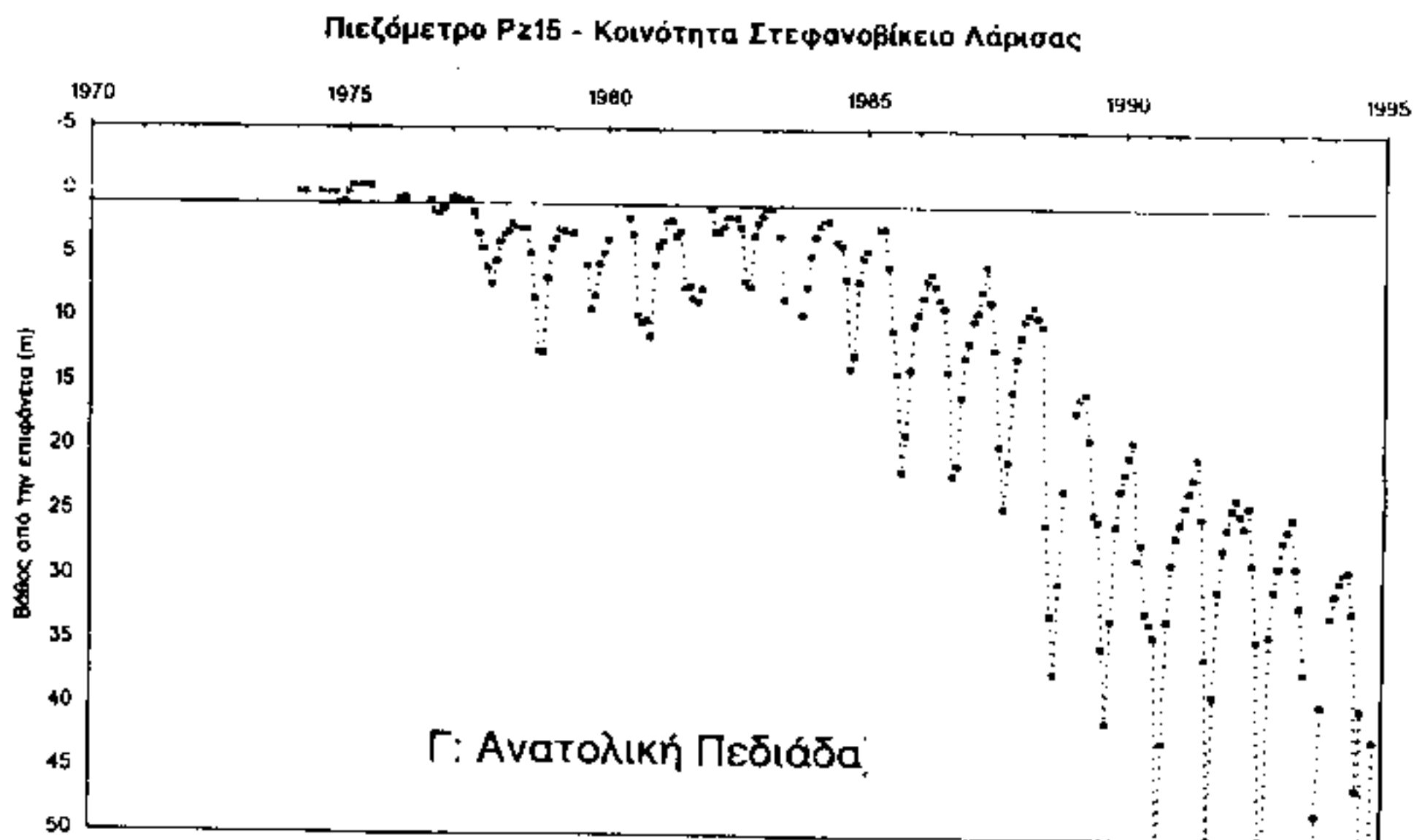
Σχ. 1 Εξέλιξη της πιεζομετρίας της Θεσσαλίας με την αύξηση των αρδεύσεων. Παράθεση 3 πιεζομέτρων ενδεικτικών των καταστάσεων σε 3 διαφορετικές περιοχές της πεδιάδας.
