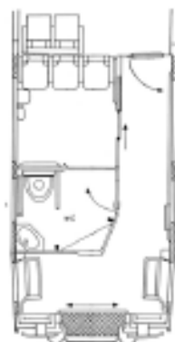
Σχέδιο διαμόρφωσης προσβάσιμου βαγονιού IC
