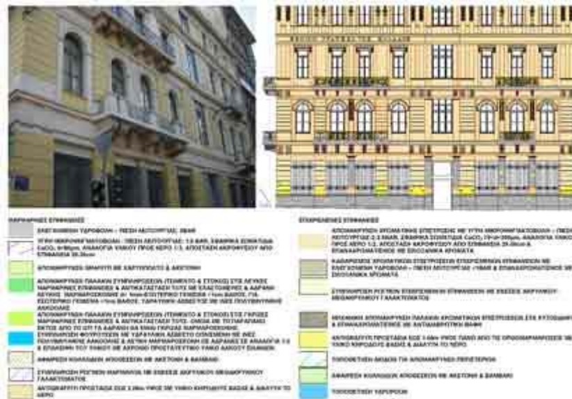
Εικ.: Φωτογραφία της ανατολικής όψης του πρώην ξενοδοχείου Excelsior (επί της οδού Πατησίων), σχέδιο της χαρτογράφησης των υλικών της ανατολικής όψης στο AutoCAD και αναλυτικό υπόμνημα της σύστασης και της μορφολογίας των υλικών.
