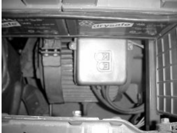
Σχήμα 3. Τριφασικός κινητήρας εναλλασσομένου ρεύματος τοποθετημένος στο Ηλεκτρικό Αυτοκίνητο.
