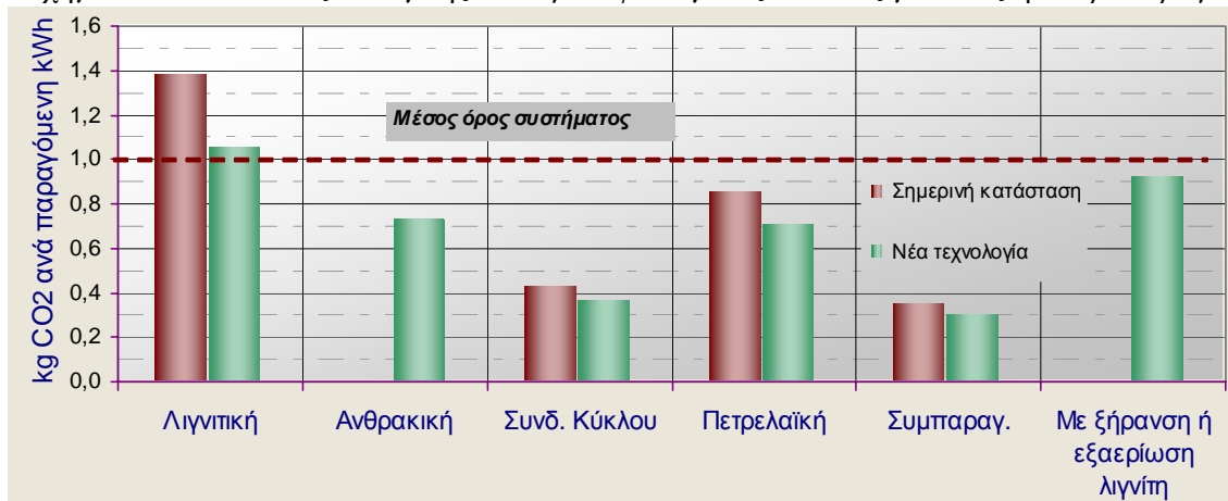
Σχήμα 8 : Συντελεστές εκπομπής CO 2 για υφιστάμενες και νέες μονάδες ηλεκτροπαραγωγής
