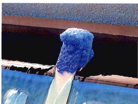
Εικ. 6. Χαλκανθίτης που σχηματίστηκε στα ανώτερα σημεία της δεξαμενής με διάλυμα εμπλουτισμένο σε καθαρό θειικό χαλκό πριν την ηλεκτρόλυση.
