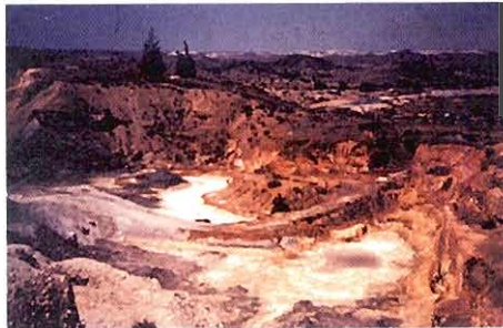
Εικ. 2. Οξειδωμένο κοίτασμα (gossan) με έντονα κόκκινα και κίτρινα χρώματα. Σε μικρό βάθος βρίσκεται το μη οξειδωμένο κοίτασμα καλυμμένο με λεπτό στρώμα ένυδρων θειικών αλάτων του σιδήρου με άσπρο χρώμα (Μεταλλείο Μαθιάτη).
