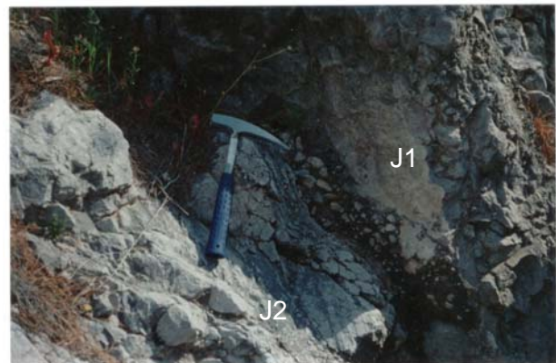
Φωτογραφία 3. Κύριες ασυνέχειες βραχώμαζας Photograph 3. Main discontinuity sets.
