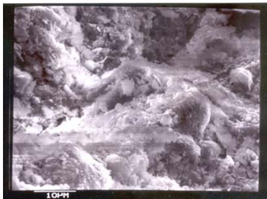
Σχήμα 10. Μικροδομή «μικτού τύπου» - δείγμα 27 (x2000).
