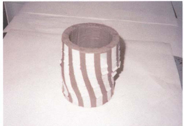
Εικόνα 2. Παραμορφωμένο δοκίμιο αργίλου σωληνοειδούς σχήματος Picture 2. Deformed hollow cylinder clay specimen
