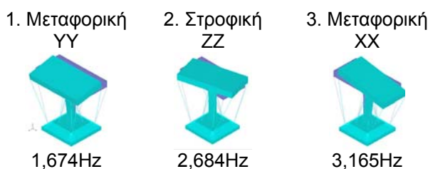
Σχήμα 8. Ιδιομορφική ανάλυση FEM. Figure 8. Modal FEM analysis.
