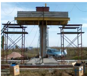
Σχήμα 1. Ομοίωμα βάρου γέφυρας. Figure 1. Bridge pier model.
