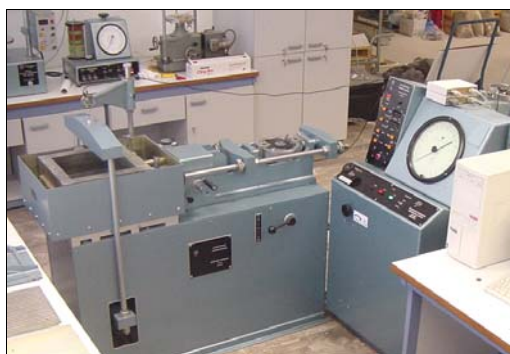
Φωτογραφία 1. Συσκευή άμεσης διάτμησης με κιβώτιο διαστάσεων 300mm x 300mm Photo 1. Large shear box (300mm x 300mm) direct shear apparatus
