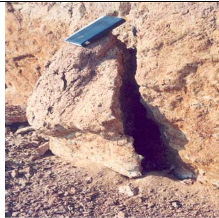
Φωτο 10. Συγκέντρωση αλάτων στην επιφάνεια του πρανούς. Photo 10. Salt concentration on the surface of the cliff
