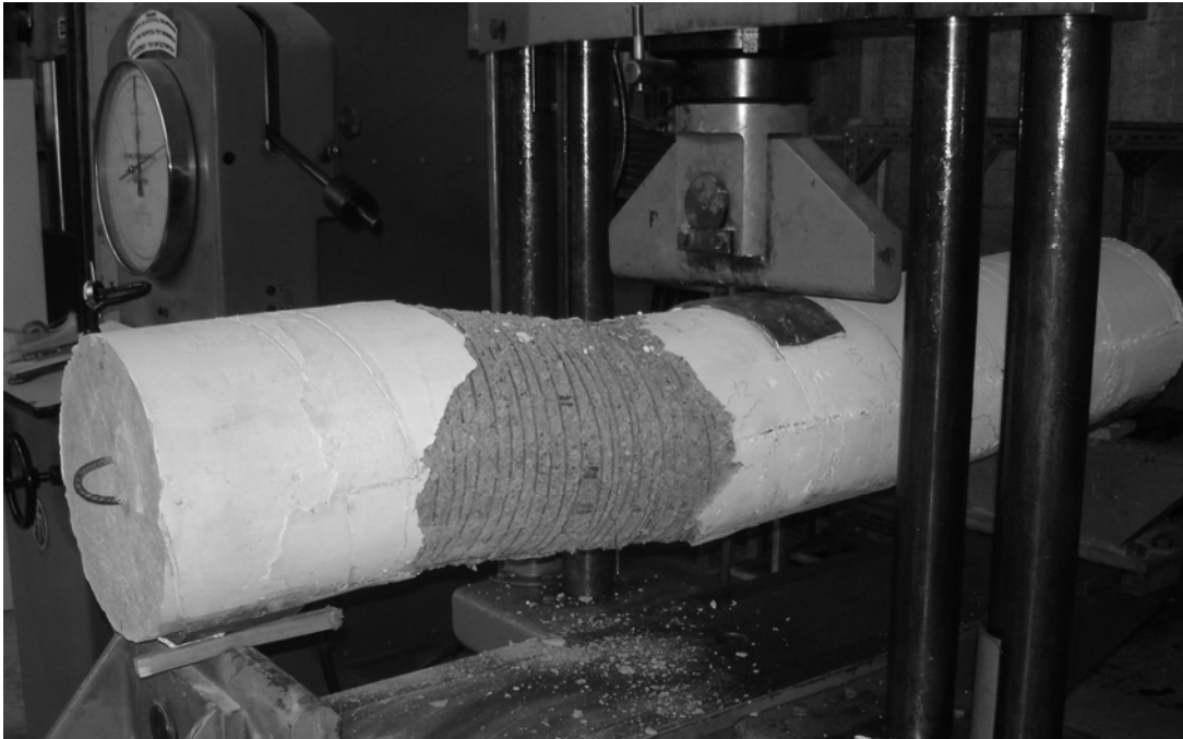
Εικόνα 2. Εικόνα αστοχίας δοκιμίου 1. Αστοχία από ανεπάρκεια των καμπύλων θλιπτήρων του σκυροδέματος
