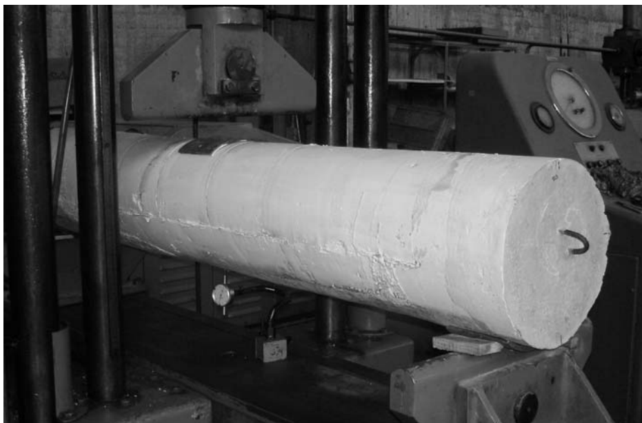
Εικόνα 1. Διάταξη φόρτισης δοκιμίων
