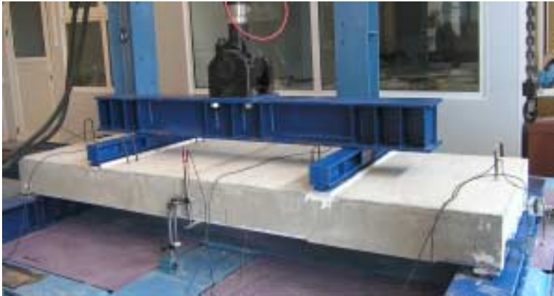
Εικόνα 1. Πειραματική διάταξη κάμψης 4-σημείων σε σύμμικτη αμφιέριστη πλάκα μήκους 2.40 m.
