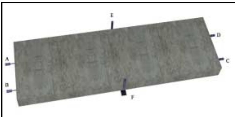
Σχήμα 1. Θέσεις μηκυνσιόμετρων στο δοκίμιο της πλάκας.
