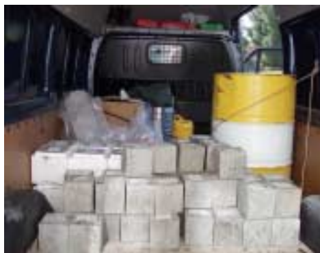
Φωτ. 12. Μεταφορά των κυβικών δοκιμίων σκυροδέματος που λήφθηκαν κατά τη σύνθεση των πύργων στο Εργαστήριο Σκυροδέματος του ΚΔΕΠ για δοκιμές
