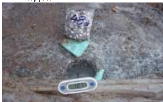
Φωτ. 15. Πυρηνοληψία σε βάση θεμελίωσης πύργου και μέτρηση θερμοκρασίας.
