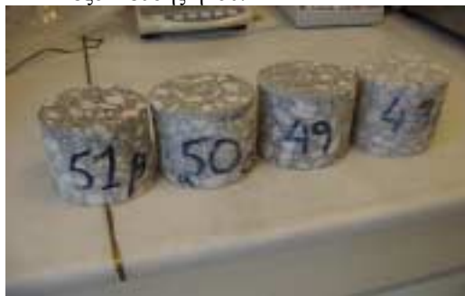
Φωτ. 16. Δοκίμια που διαμορφώθηκαν από πυρήνες που λήφθηκαν από τις βάσεις θεμελίωσης.
