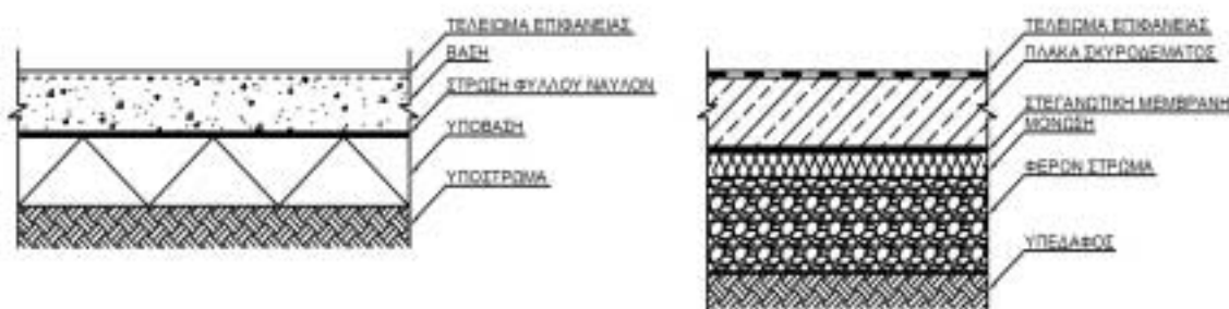
Σχήμα 3. Δύο περιπτώσεις πλάκας επί εδάφους από σκυρόδεμα
