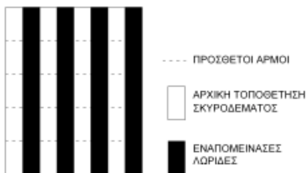
Σχήμα 4. Τεχνική διάστρωσης των εναλλασσόμενων λωρίδων
