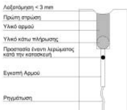
Σχήμα 9. Επισφράγισμα αρμών σύμφωνα με την ZTV Fug-StB 01
