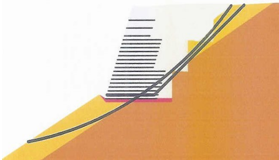
Σχήμα 2: Κρίσιμες επιφάνειες αστοχίας τυπικής διατομής του έργου, ReSSa. Figure 2: Critical failure surfaces on a typical cross-section of the project, ReSSa.
