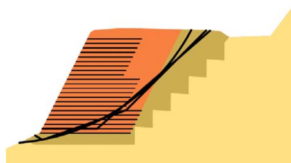
Σχήμα 7. Επιφάνειες θραύσης λόγω σεισμικής δράσης από το λογισμικό ReSSA.
