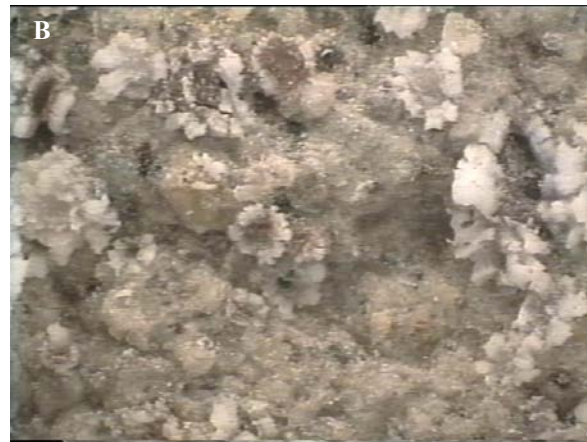
Εικόνα 2. Α: Το Καμπαναριό στον ναό του Αγ. Ιωάννη, Σύμη. Β: Μικροσκοπία Οπτικών Ινών – Μεγέθυνση x25, Δημιουργία εξανθήσεων αλάτων σε επιφάνεια σκυροδέματος σε θαλάσσιο περιβάλλον
