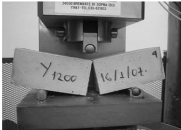
Σχήμα 1: Πρότυπη συσκευή καμπτικής καταπόνησης κονιαμάτων
