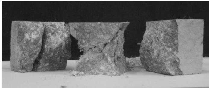
Σχήμα 9: Θραύση δοκιμίων κονιάματος υπό θλίψη
