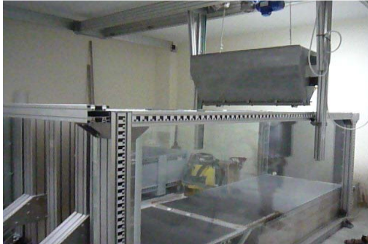
Σχήμα 2. Φωτογραφία της Συσκευής Ελεγχόμενης Διάστρωσης Άμμου εν λειτουργία, αμέσως μετά την έναρξη διάστρωσης άμμου εντός του κιβωτίου της Συσκευής Προσομοίωσης Σεισμικής Διάρρηξης.
