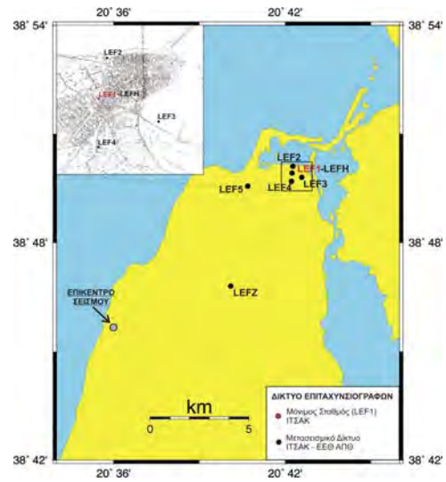
Σχήμα 2. Μετασεισμικό δίκτυο επιταχυνσιογράφων του ΙΤΣΑΚ
