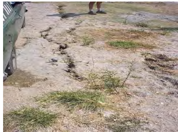
Σχήμα 9. Λευκάδα – Είσοδος (βορείως της πλωτής γέφυρας): Αστοχία κρηπιδώματος. Σχήμα 10. Νυδρί – Λιμένας: Ρευστοποίηση εδάφους με ανάδυση λεπτόκοκκου υλικού
