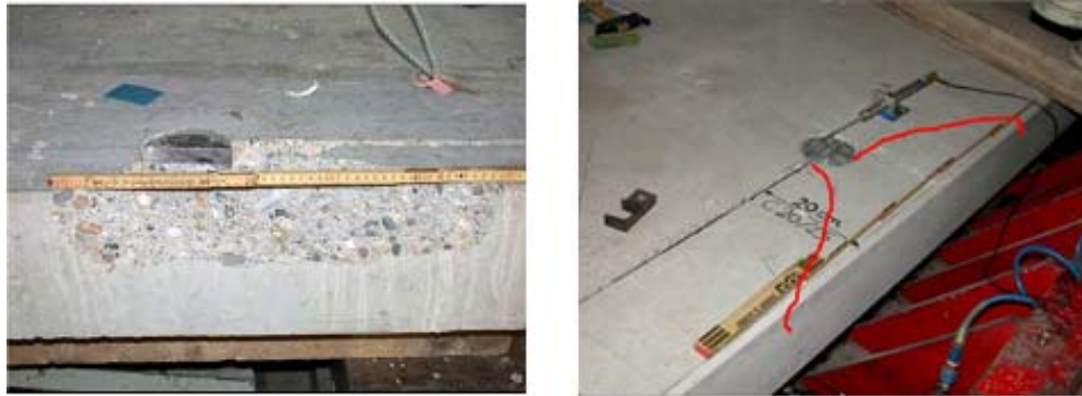
Σχήμα 8. Περιπτώσεις αστοχίας σκυροδέματος με επιρροή του ορίου
