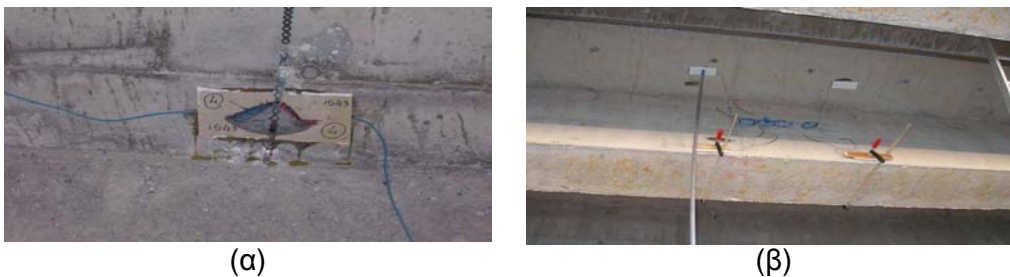
Σχήμα 4. (α) Εξωτερικά επιθέματα προστασίας αισθητήρων (β) Εφαρμογή πίεσης στους αισθητήρες.
