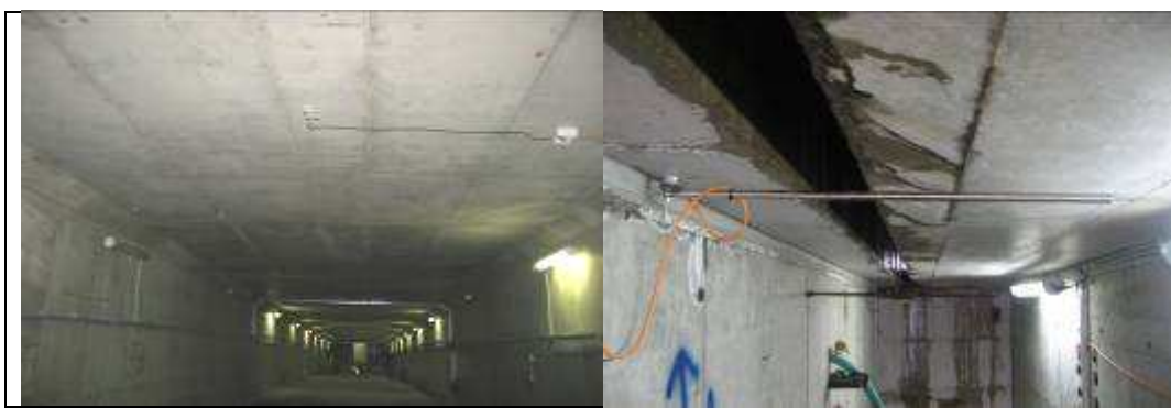
Σχήμα 1. Αισθητήρες δυναμικής μέτρησης: (α) παραμόρφωσης, (β) μετακίνησης αρμού
