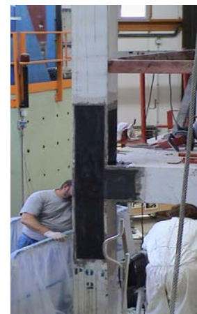
Σχήμα 5. Τοποθέτηση ΙΟΠ σε οριζόντια και κατακόρυφη μορφή
