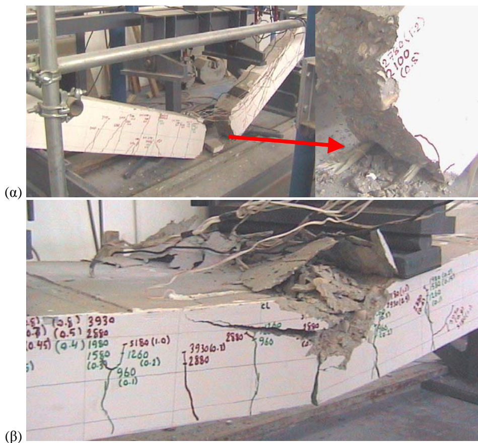
Σχήμα 2. Αστοχία σε κάμψη δοκών οπλισμένου σκυροδέματος με ΙΩΠ: (α) σύνθλιψη του σκυροδέματος και (β) εφελκυστική αστοχία του διαμήκους οπλισμού (Al-Sunna, 2006)
