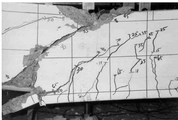
Σχήμα 3. Δοκός ΟΣ με κύριο οπλισμό από ΙΩΠ: αστοχία σε διάτμηση
