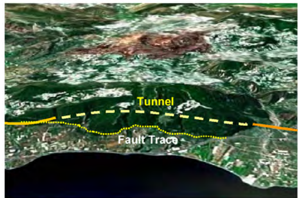
Σχήμα 3. Μορφοανάγλυφο της περιοχής της σήραγγας και ίχνος του ενεργού ρήγματος. Figure 3. Morphology of the tunnel area and active fault trace.
