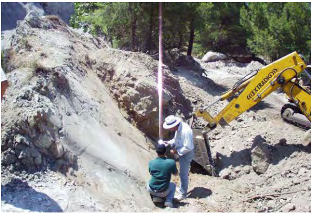
Σχήμα 6. Η κατοπτρική επιφάνεια του ρήγματος στην περιοχή του στομίου εισόδου κατά τις εργασίες χαρτογράφησης του. Figure 6. The fault plane at the entrance portal area, during the site investigation works.
