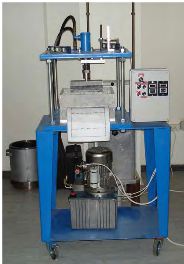
Σχήμα 1. Εργαστηριακή διάταξη (ENV ISO 10722-1).
