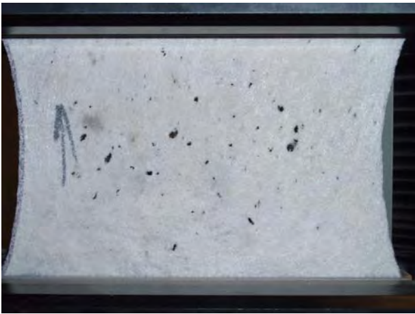
Σχήμα 4. Παρατήρηση φθοράς με μορφή διάτρησης κατά την εκτέλεση δοκιμής εφελκυσμού. Figure 4. Damage observed as holes on geotextile specimen during tensile testing.
