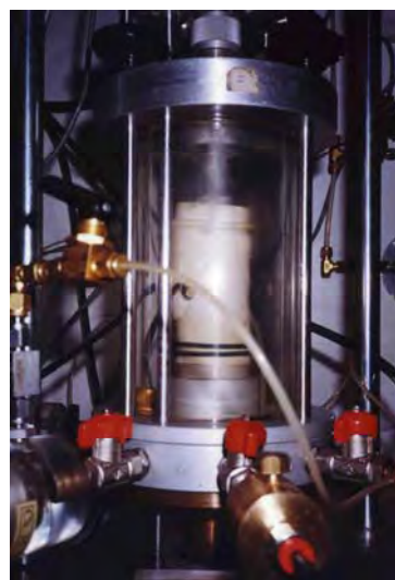
Σχήμα 3. Το δοκίμιο στο τέλος της διάτμησης της δοκιμής 1.
