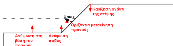
Σχήμα 1. Τυπική γεωμετρία πρανού και κύριες μετακινήσεις.
