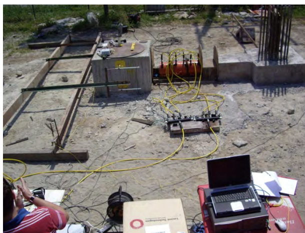
Φωτογραφία 1. Διάταξη δοκιμαστικής φόρτισης Photograph 1. Pile test arrangement
