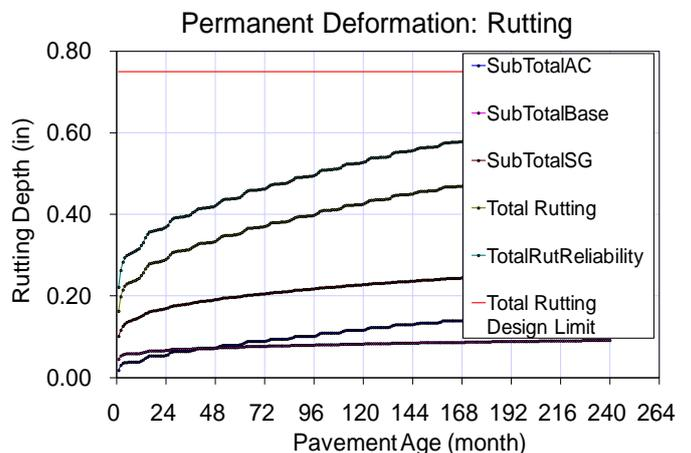
Σχήμα 5. Παραδειγμα αποτελεσματος: Πλαστική παραμορφωση
