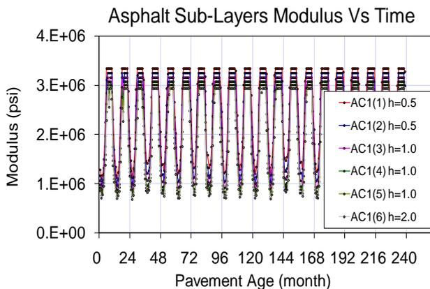
Σχήμα 2. Παράδειγμα της εποχιακής μεταβολής στο δυναμικό μέτρο ελαστικότητας ( $E^*$ ) του ασφαλτικού σκυροδέματος
