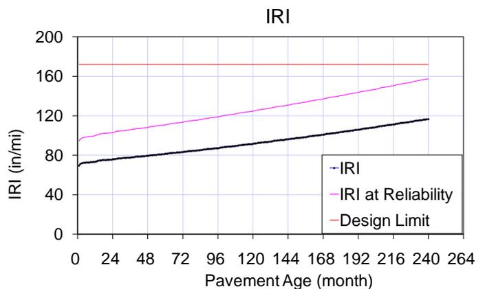
Σχήμα 6. Παραδειγμα αποτελεσματος: Ομαλοτητα (IRI)
