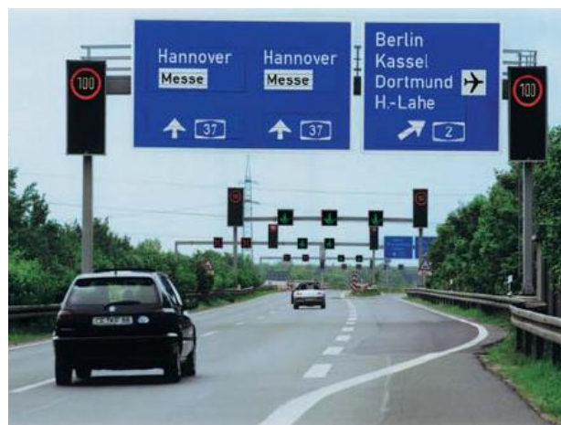
Σχήμα 12. Πληροφοριακή πινακίδα μεταβλητού περιεχομένου αλλαγής προορισμού - Άμεση σήμανση με την οποία εξυπηρετείται η αποσυμφόρηση του οδικού τμήματος
