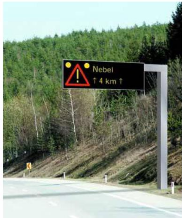
Σχήμα 10. Παράδειγμα πινακίδας αναγγελίας πληροφοριών – Αναγγελία ομίχλης μετά 4km
