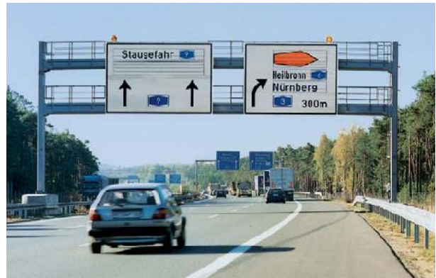
Σχήμα 11. Πρόσθετη πληροφοριακή πινακίδα μεταβλητού περιεχομένου - Συμπληρωματική σήμανση με την οποία συνιστάται παράκαμψη λόγω κυκλοφοριακής συμφόρησης
