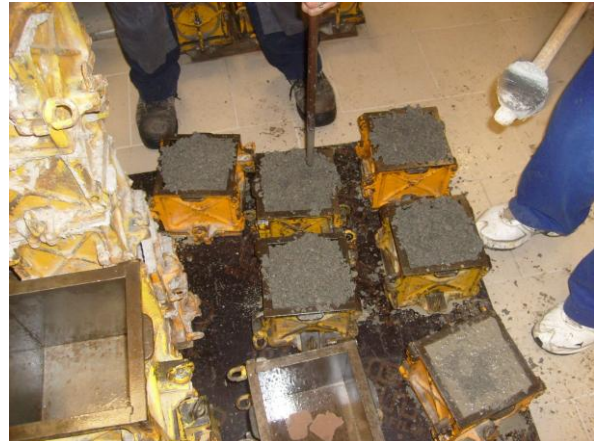
Σχ. 3 Λήψη δοκιμίων και συμπίκνωση με ράβδο
