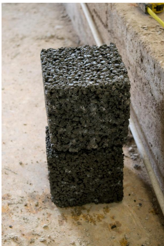
Φωτ.1 Εικόνα διαπερατού σκυροδέματος
