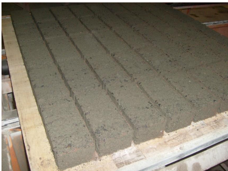
Φωτ.6 Νωποί διαπερατοί κυβόλιθοι οδοστρώσας με σκωριοαδρανή
