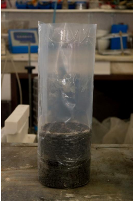
Φωτ.2 Πλευρική επικάλυψη με μεμβράνη
