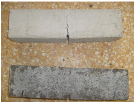
Σχ. 1 Δοκίμια με σκωριοαδρανή (κάτω) και ασβεστολιθικά αδρανή (πάνω) μετά τη δοκιμή σε κρούση
