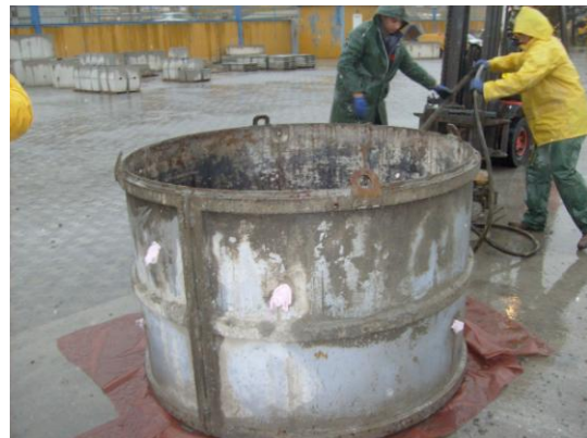
Σχ.2 Μήτρα για τη σκυροδέτηση ογκόλιθου σε φυσικό μέγεθος
