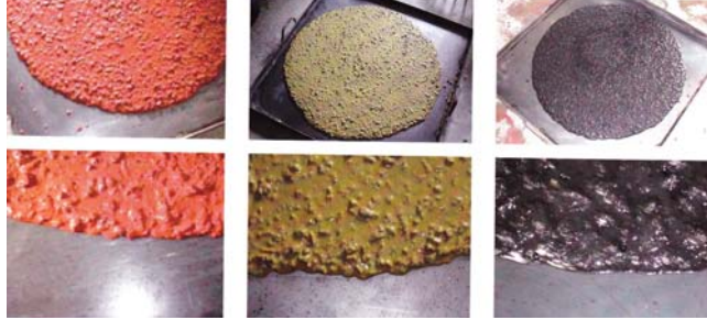
Σχ.22. Δοκιμές κάθισης σε έγχρωμα αυτοσυμπυκνούμενα σκυροδέματα
