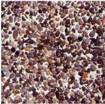
Σχ.17. Απογυμνωμένο σκυρόδεμα με έγχρωμα αδρανή
