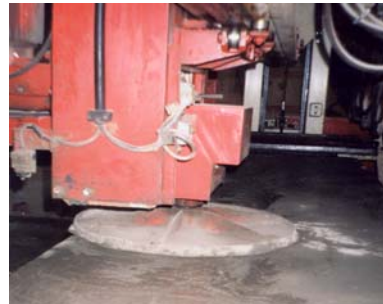
Σχ.14.Βιομηχανική επεξεργασία λείανσης προκατασκευασμένου στοιχείου
