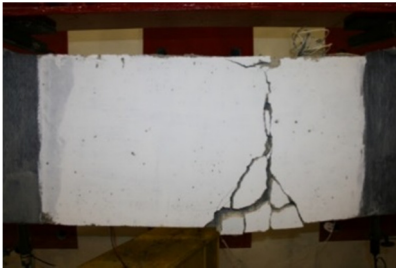
Σχ. 1 Όψη ανοίγματος δοκού έπειτα από αστοχία του χάλυβα σε κόπωση
