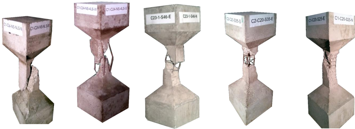
Εικόνα 1. Τελικές εικόνες αστοχίας πειραματικών δοκιμών με διαφορετική πύκνωση συνδετήρων
