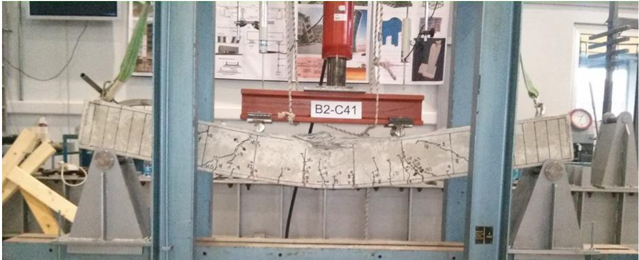
Σχ.1. Τελικό στάδιο φόρτιση και αστοχίες δοκού Ο/Σ
