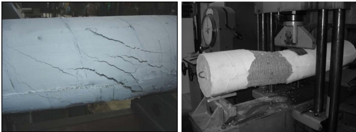
Σχ. 2 Εικόνα διατμητικής ρηγμάτωσης και αστοχία από ανεπάρκεια των καμπύλων θλιπτήρων του σκυροδέματος
