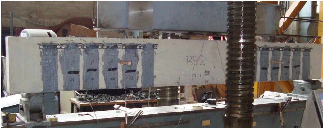
Εικόνα 1. Φωτογραφική απεικόνιση της πειραματικής φορτιστικής διάταξης με δοκίμιο ορθογωνικής διατομής ενισχυμένο διατμητικά με λωρίδες ινοπλισμένων πολυμερών
