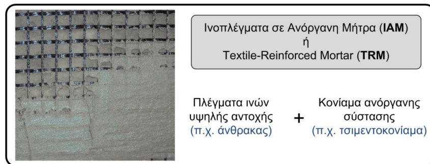
Σχ. 1. Εποπτική περιγραφή του σύνθετου υλικού ενίσχυσης τύπου Ινοπλέγατος σε Ανόργανη Μήτρα (IAM).
