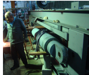
Εικόνα 3. Μεταλλική φορτιστική συσκευή μεγάλων διατάσεων για τον έλεγχο της συμπεριφοράς του κάθε ενός ελατηρίου
