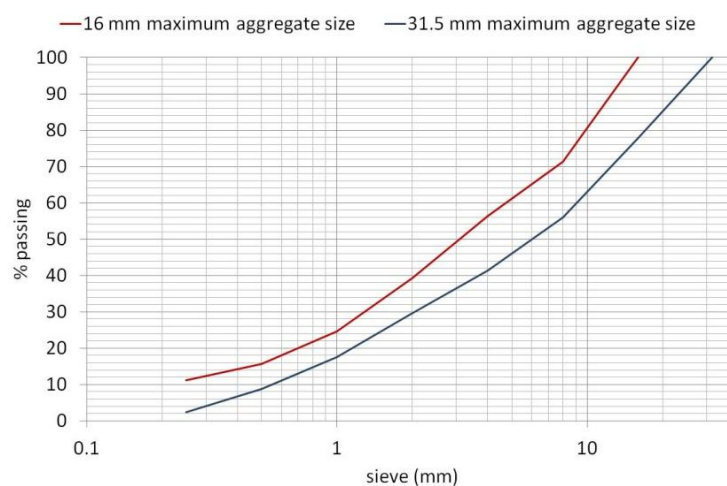
Σχ. 1 Κοκκομετρικές καμπύλες ασβεστολιθικών αδρανών με μέγιστο κόκκο 16 και 31.5 mm
