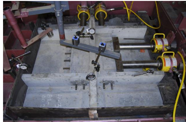
Σχ. 4 Δοκιμή διαξονικής θλίψης κόμβων
