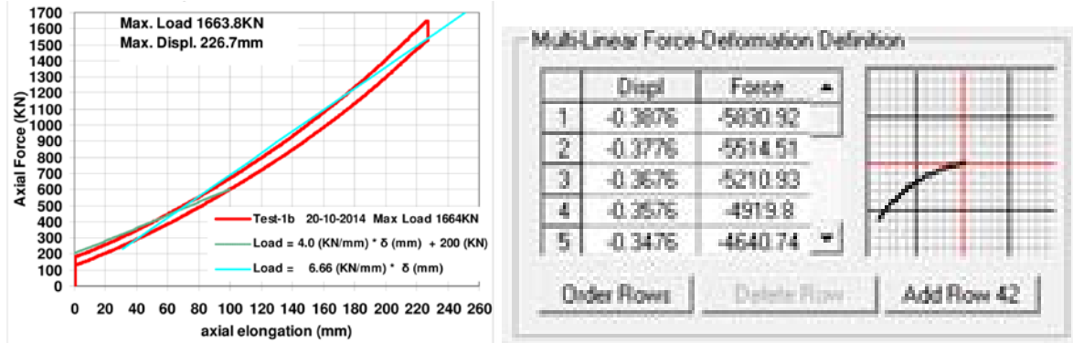
Σχ. 9 Συμπεριφορά ελατηρίων κατά την δοκιμή τους στο ΑΠΘ και προσομοίωση στο SAP2000
